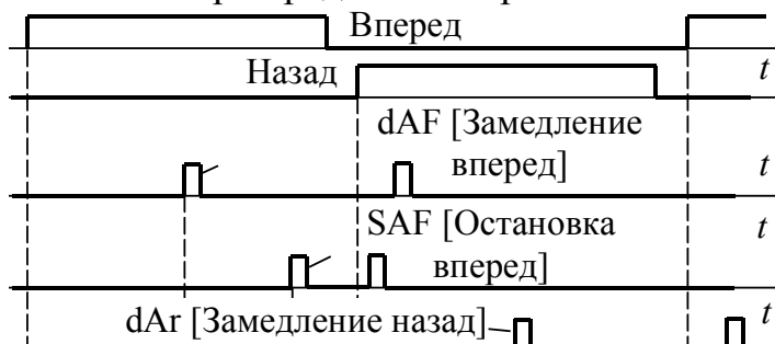
Рис. 9.10 Процесс позиционирования при средних копирах
