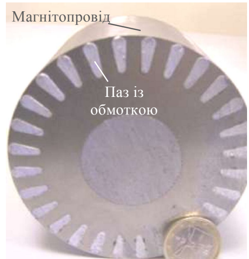
Рис. 10 Ротор асинхронного двигуна: а – короткозамкнена обмотка, б – поперечний переріз ротору
