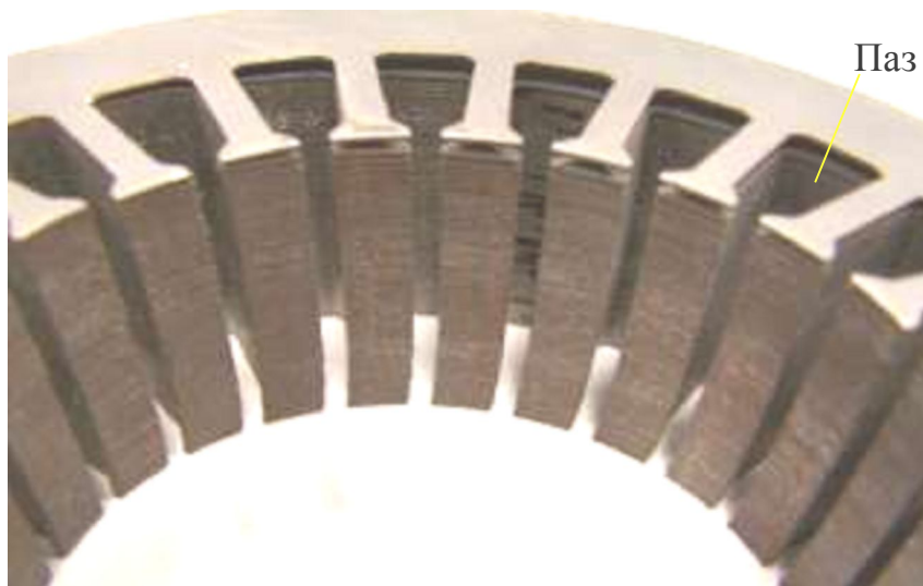
Рис. 5 Магнітопровід статора двигуна змінного струму
