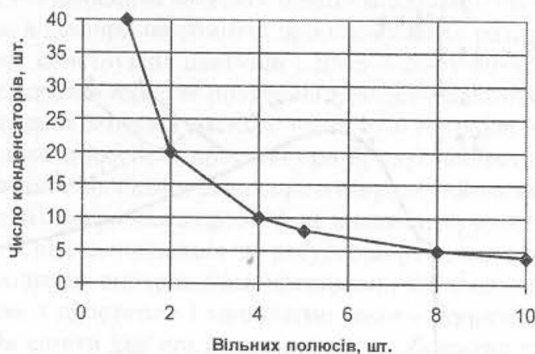
Рис. 5. Залежності впливу числа вільних полюсів на параметри конденсаторів
