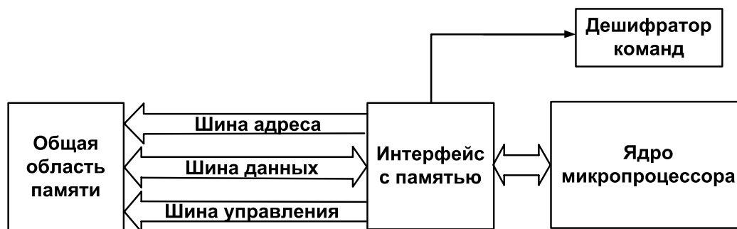
Рис. 5.28. Микропроцессорная система с неймановской архитектурой
