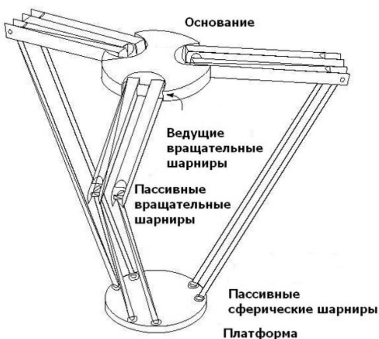
Рис. 3.42. Схема дельта-механизма
