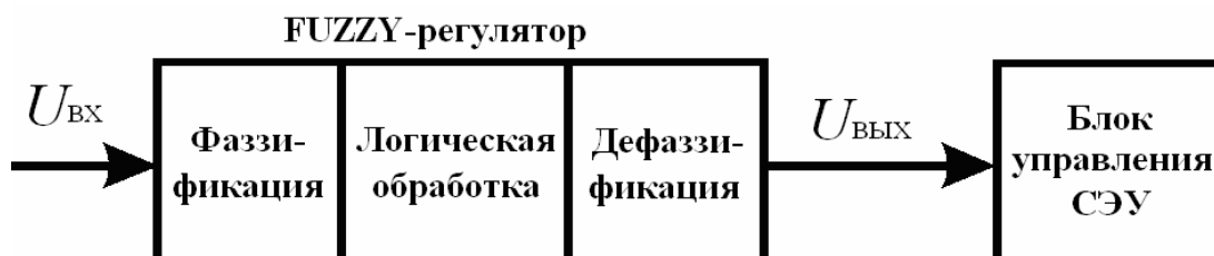
Рис. 7.10. Этапы обработки сигнала фаззи-регулятора
