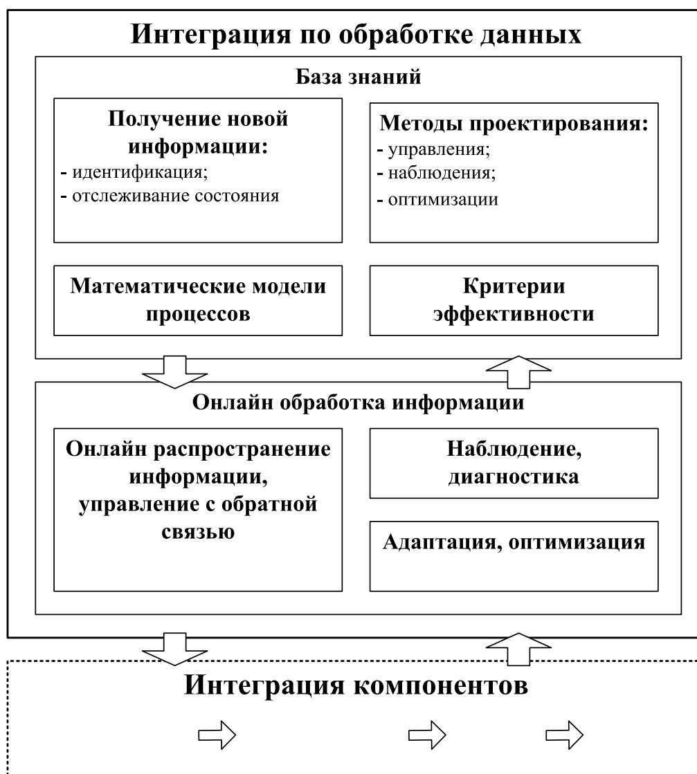
Рис. 4.1. Интеграция составных частей мехатронного устройства
