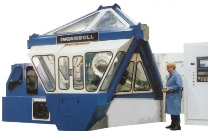
Рис. 3.48. Широкоуниверсальный обрабатывающий центр Octahedral Hexapod HON-600
