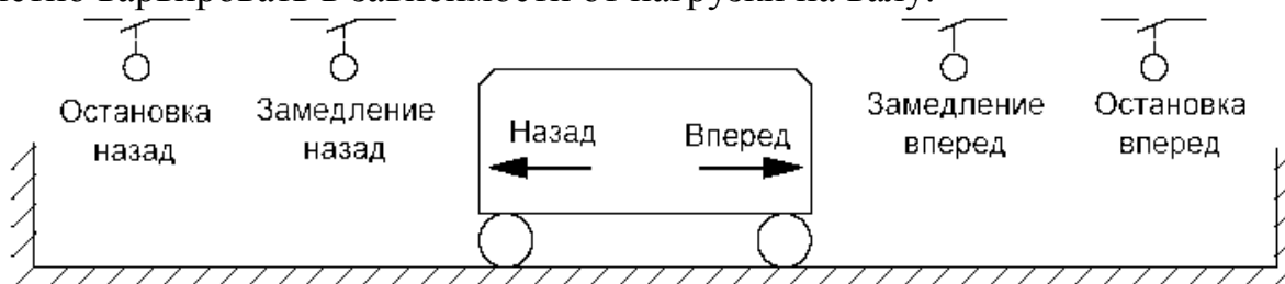
Рис. 5.11 Позиционирование по двум выключателям
