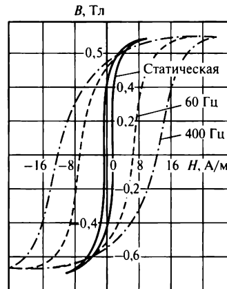
Рис. 3.6. Петли гистерезиса, снятые при питании от источника синусоидального напряжения
