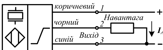
Рис.48. Умове графічне позначення та схема під'єднання ультразвукового давача зі струмовим аналоговим виходом
