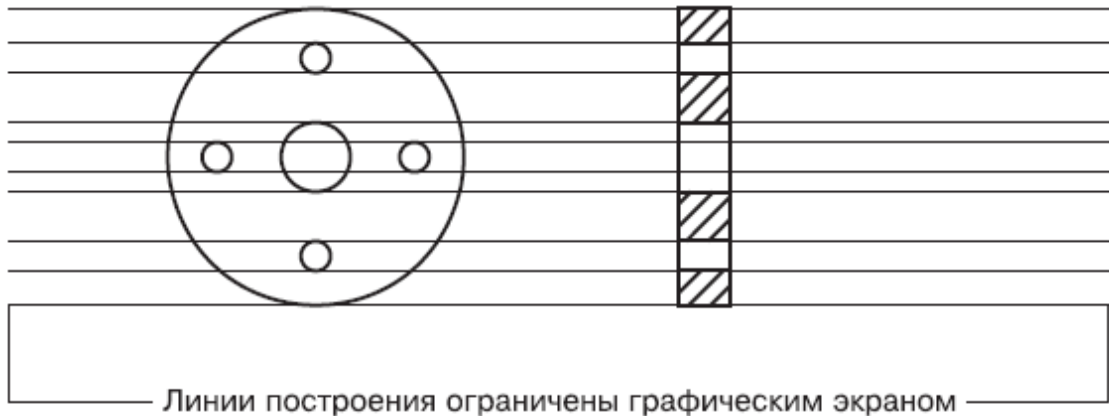
Рис. 2.15. Применение прямых для связи различных проекций одной детали
