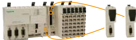
Контроллер перемещения LMC058 LF424
