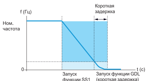
Действие функции безопасности GDL (пример остановки: SS1)
