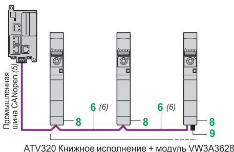
Пример подключения к шине CANopen с использованием клеммников с винтовыми зажимами
