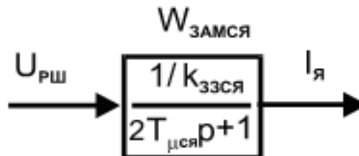
Рис. 2.4. Спрощена передавальна функція замкненого контуру струму
