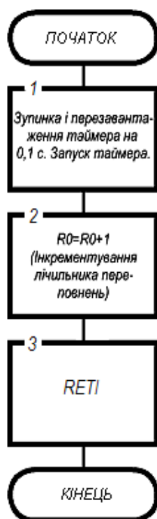
Рис. 33 Алгоритм підпрограми обслуговування запиту на переривання від таймера T/C0 при його переповнюванні
